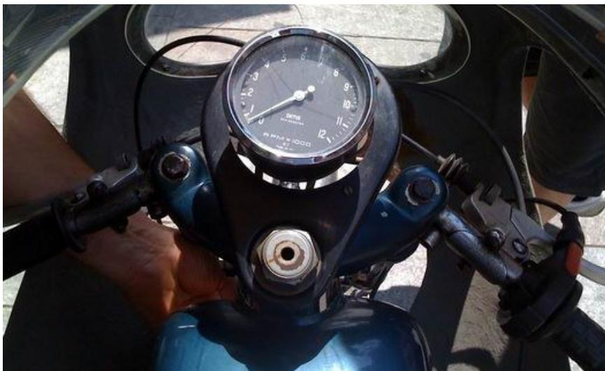
Ecco il prestigioso contagiri meccanico Smiths, la cui installazione richiedeva una precisa foratura del carter sinistro del motore e la sistemazione di un lunga guaina per il filo di collegamento diretto all'estremità dell'albero motore.
